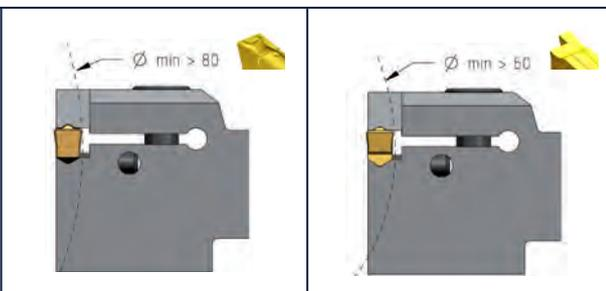
Mit einer Plattensitzgröße zwei Stechbreiten 5 mm oder 6,5 mm abdecken.
