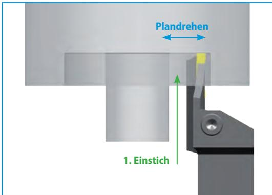
Jede Kasette bzw. jeder Monoblockhalter ist für einen bestimmten Durchmesserbereich ausgelegt. Dieser Bereich ist durch die Maße  $\varnothing$  min -  $\varnothing$  max gekennzeichnet.
