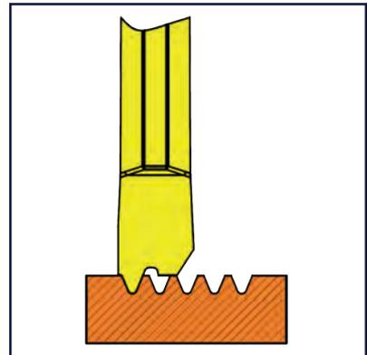
Die Spitze des Gewindeprofils wird durch eine zweite Schneidkante bearbeitet.
