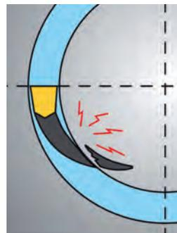
Die Skizze zeigt den Folgeschaden, der entsteht, wenn der erste Einstich  $>$  als  $\varnothing$  max ist: Die **Innenseite** der Kasette kollidiert mit dem Werkstück.
