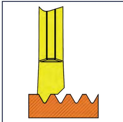
Beim Vollprofil wird das komplette Gewindeprofil gedreht. Vollprofilplatten sind daher immer nur für eine bestimmte Gewindesteigung und Norm ausgelegt!
