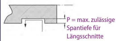
Ist die geometrische Spantiefe, bezogen auf die Nebsschneiden der unterschiedlichen Stechgeometrien.
