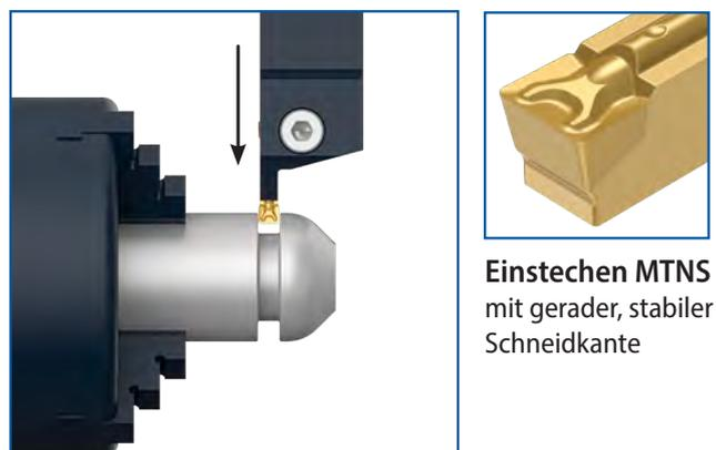
Einstechen ist ein Zerspanungsvorgang, bei dem mit einer Stechdrehplatte (mit geeigneter Stechgeometrie) Nuten eingestochen werden.
