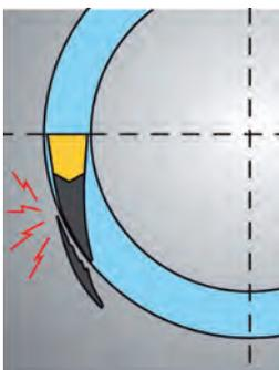
Die Skizze zeigt den Folgeschaden, der entsteht, wenn der erste Einstich  $<$  als  $\varnothing$  min ist: Die **Außenseite** der Kasette kollidiert mit dem Werkstück.
