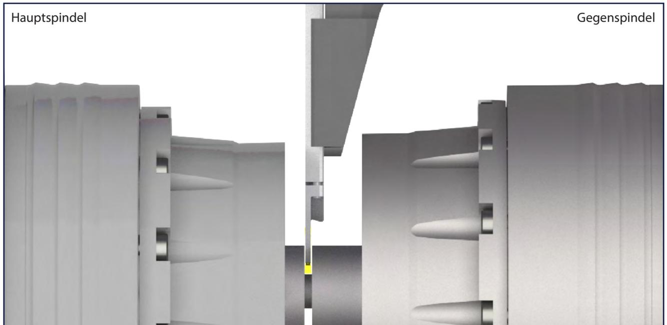
Bearbeitung in beengten Bauräumen (z.B. Arbeiten mit Gegenspindel)
