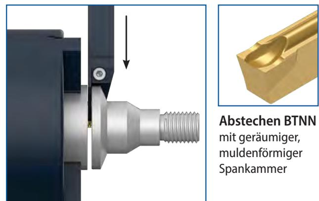
Abstechen ist ein Zerspanungsvorgang, bei dem ein Teil von der Materialstange abgetrennt wird.
