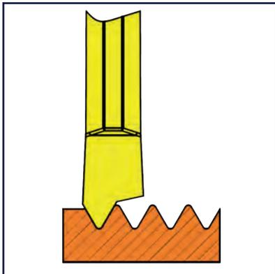
Das Teilprofil berührt den Nenndurchmesser beim Gewindedrehen nicht. Daher ist diese Platte für verschiedene Steigungen (innerhalb eines bestimmten Steigungsbereiches) geeignet.
