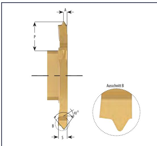
Präzisionsgeschliffene Gewindeschneidplatten für Außengewinde
