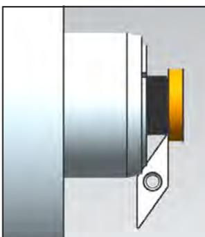
Konturschlichtbearbeitung in beengtem Bau-
