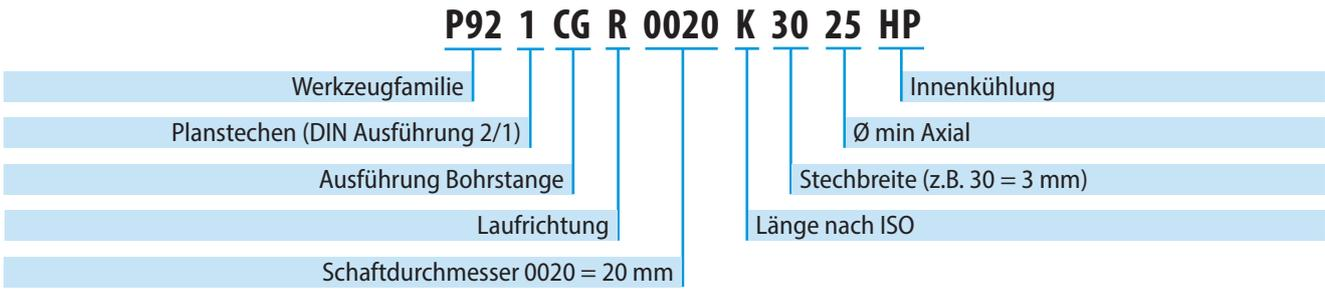
**Bohrstangen zum Innenaxialstechen mit Innenkühlung und kurzer Auslage**
