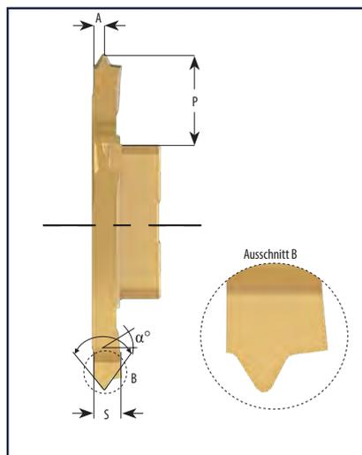
**Präzisionsgeschliffene Gewindeschneidplatten für Außengewinde**
