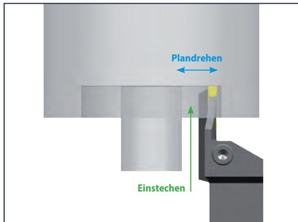
Skizze zeigt den zulässigen Einstechbereich für die Kassette, der mit  $\varnothing$  min -  $\varnothing$  max gekennzeichnet ist..
