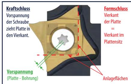
Vertikal in Plattensitz eingebaute Platten sind ein bekannter Stand der Technik. Der neue technisch vorteilhafte Stand sind jedoch die segmentierten MULTICUT 4-Schneidkörper. Diese Neuentwicklung weist entscheidende Vorteile auf:
